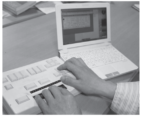
写真 点字入力用のキーボード(左)で入力した点字は、パソコンで文字や音声として出力される
