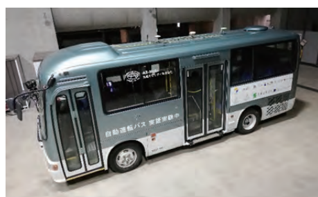
写真1 自動運転バスの車両。2019年11月から、柏の葉キャンパス駅と東京大学柏キャンパス間の、住宅街や公道が含まれる約2.6kmのルートでの走行実験を実施中。
