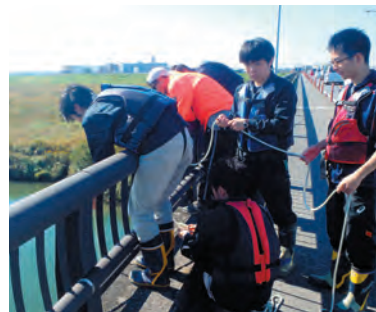
写真 橋の上から重しをつけた観測機材を川底に下ろし、河川におけるマイクロプラスチック調査と水質調査を行っている様子。
