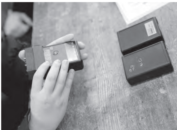
夜空班が夜空の明るさを測定する時に使用している機器。街灯の光まで拾ってしまうことが課題であったため、相澤さんは、余計な光を遮るための木製のフードを作製。写真のように、それを機器に装着することで、正確な測定が可能になった。夜空班では、このフードを光害の研究をしている他校にも配りたいと考えている。
