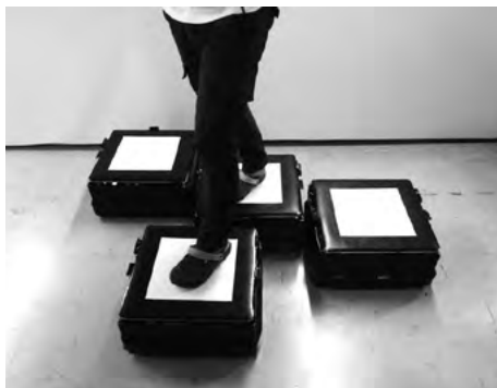
写真 タイルに乗っている人間が足を踏み出す度に、近くにある別のタイルが自動的に人間の足下まで移動してくる
